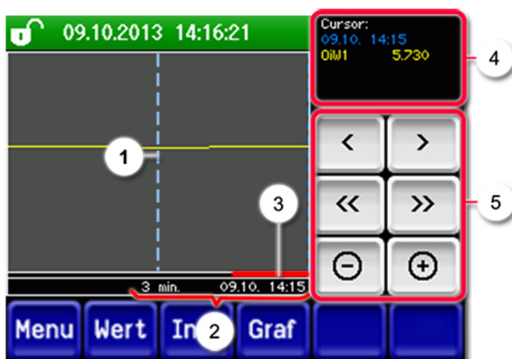
Abbildung 11: Funktionen der Log-Anzeige
