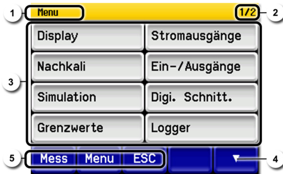
Abbildung 13: Eingabelemente im Servicebetrieb
