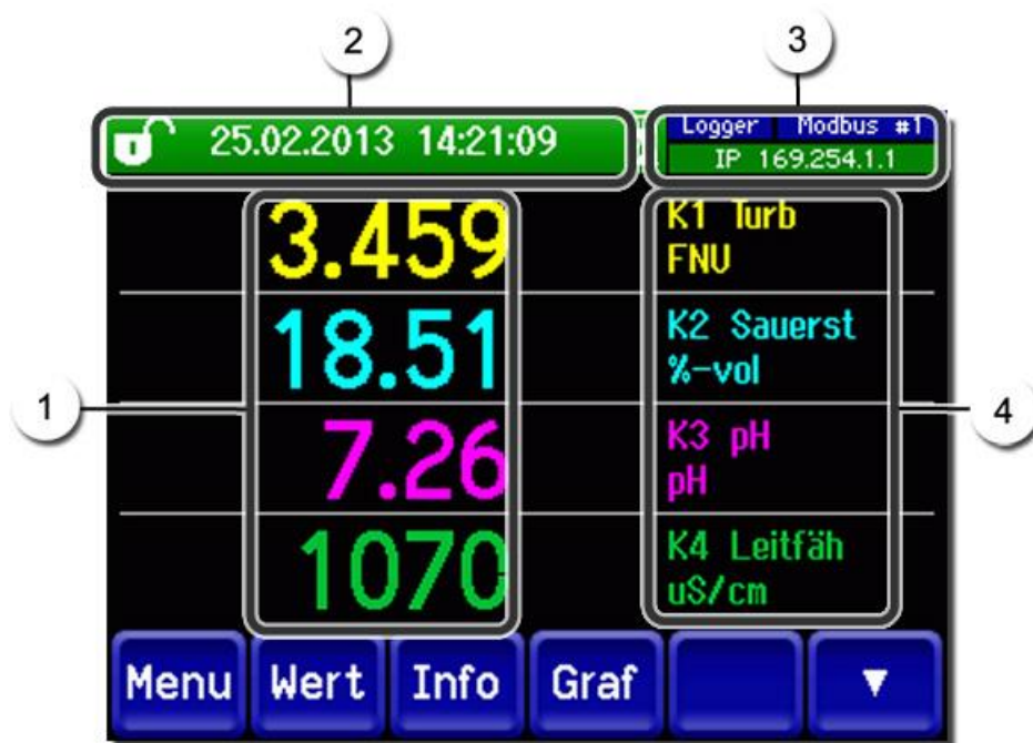
Abbildung 9: Anzeigen im Messbetrieb
