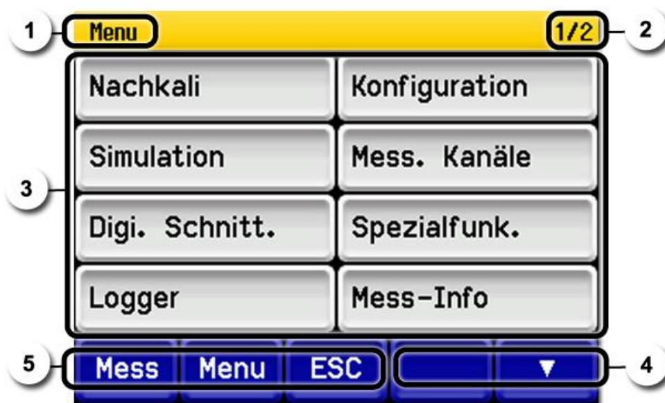
Abbildung 8: Eingabelemente im Servicebetrieb
