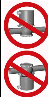
Abbildung 5: Einbau- lage falsch
